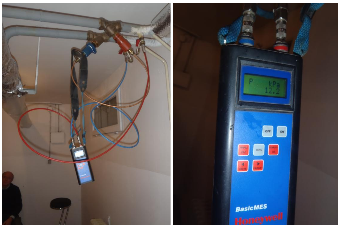
Obr.7 – Měření tlakové difference topné vody v tlakově chráněné oblasti
